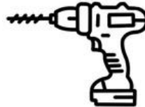
Bohrmaschine mit: Bohrer 4,2 mm Gewindeschneider M5
