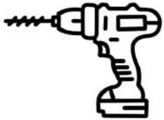
Bohrmaschine mit Bohrern 4,2 mm und Gewindeschneider M5
