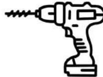
Bohrmaschine mit: Bohrer 4,2 mm Gewindeschneider M5
